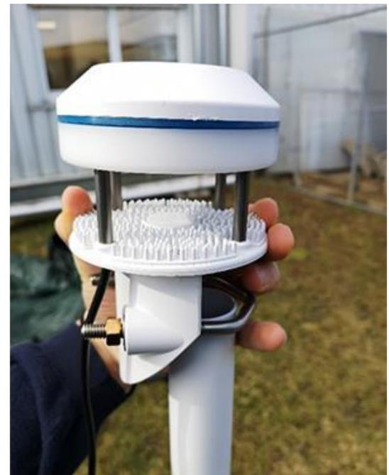
Abb. 2: Windsensor ATMOS 22 der Fa. METER Group
