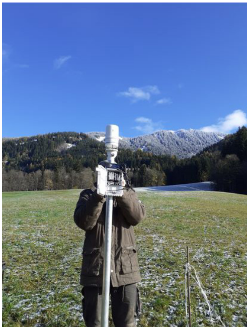
Abb.: Aufbau der Atmos 41 All-In-One Wetterstation in Oppenberg (Stmk, Österreich)
