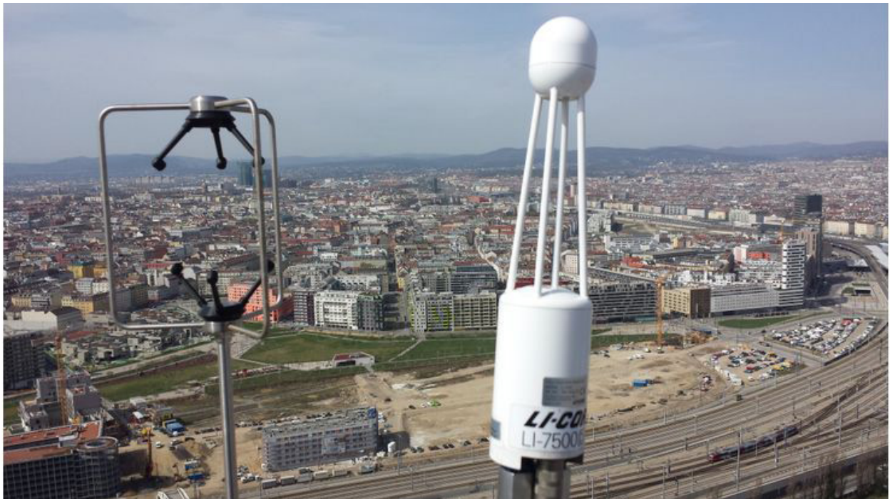
Abb.: Eddy-Kovarianz-Messsystem auf der Plattform des Arsenal Funkturms
