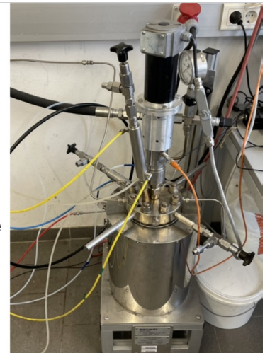
Abbildung 1: Schema der Karbonatisierung von CO 2 (links), Batchreaktor zur direkten wässrigen Karbonatisierung (rechts).
