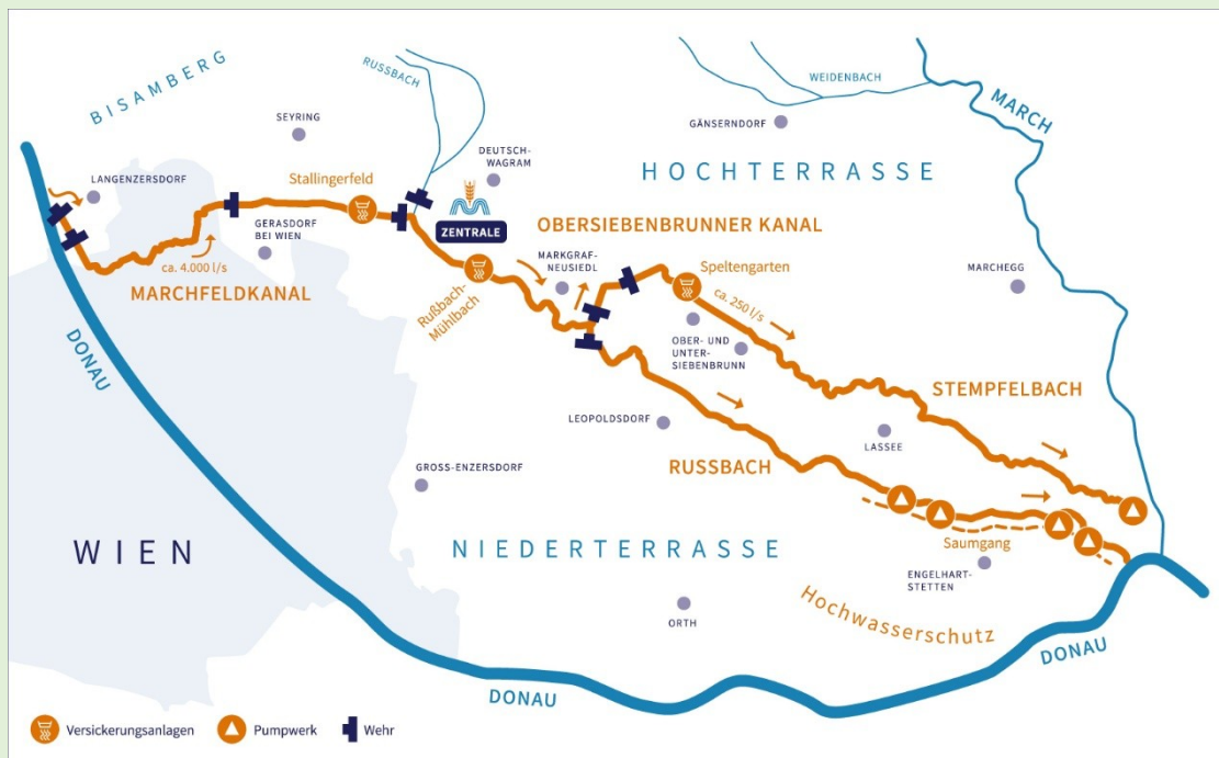
Abbildung 23: Lageplan des Marchfeldkanalsystems © Betriebsgesellschaft Marchfeldkanal
